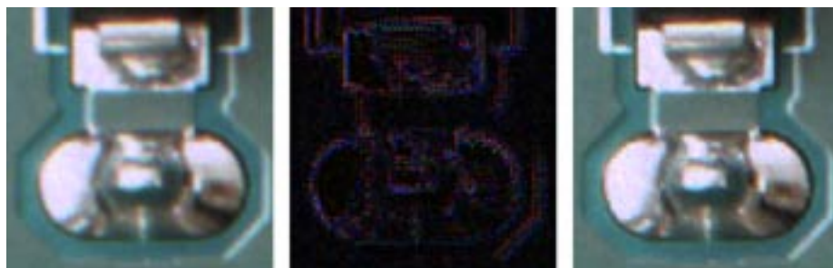
Obr. 3: Rozdílový obraz mezi bilineární a adaptivní interpolací
