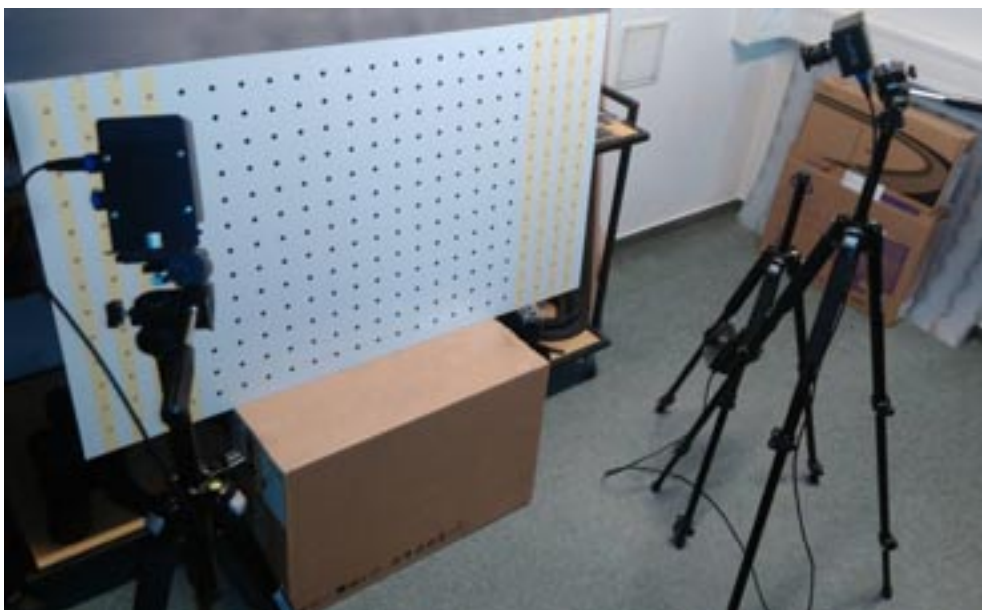
Obr. 1: Testování pohledů jednotlivými kamerami na kalibrační obrazec umístěný ve vztahné rovině.
