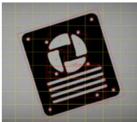
Obr. 4: Identifikace geometrických útvarů a jejich vzájemných relací
