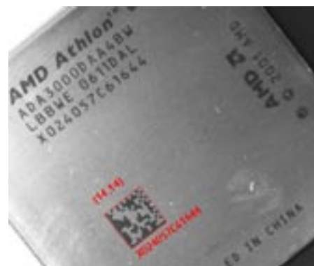
Obr. 2: Identifikace obrazce datamatrix kódu
