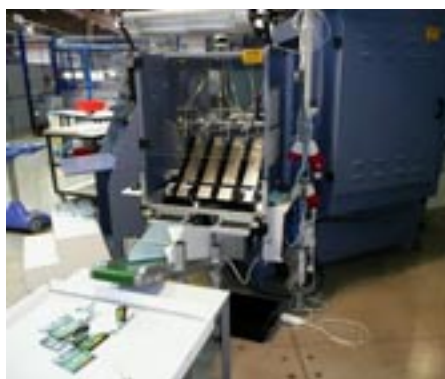
Obr. 6: Zařazení testeru na výstup balicího karuselu
